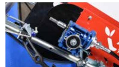
(23) Installer la visseuse sur le bras de la machine en enfonçant le mandrin sur l'arbre hexagonal.
