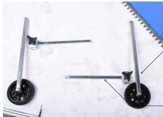
(14) Assembler le tube horizontal de la roue avec le tube vertical du rabatteur : la vis étoile doit se trouver de l'autre côté de la roue.
