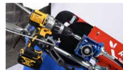
(25) Ajuster le positionnement de la pièce assurant la commande d'action de la visseuse et serrer la visseuse à l'aide de la grenouillère en plastique
